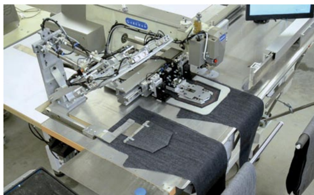
Conjunto dobrador de bolso incorporado a máquina. Máquina tem sensor de fim da bobina e das agulhas.
